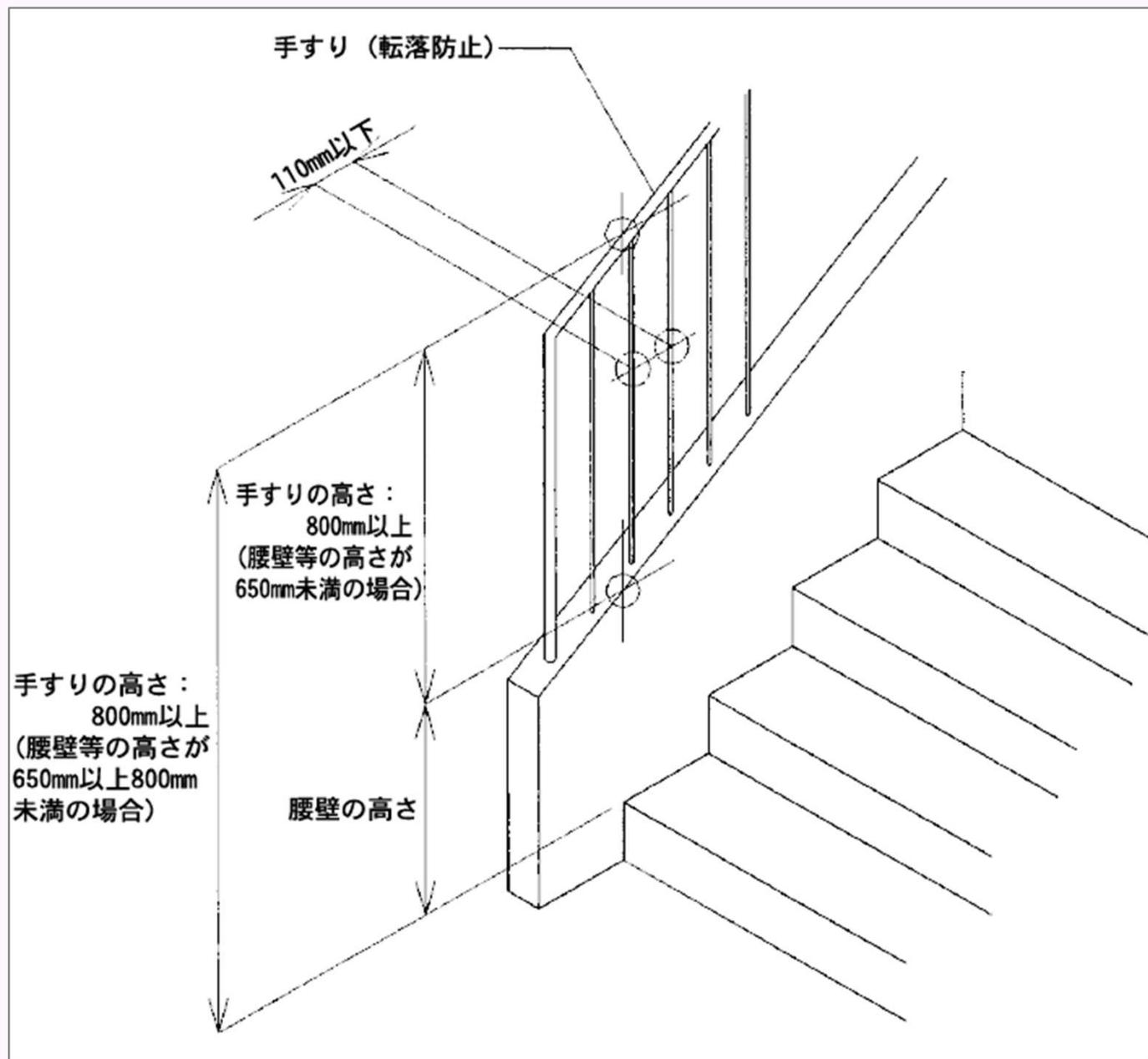
転載:『日本住宅性能表示基準・評価方法基準 技術解説(新築住宅)2022』(編集 (一財)日本建築センター), 2023年1月,P506,図9-9転落防止のための手すり(手すりの高さ、手すり子の間隔)
